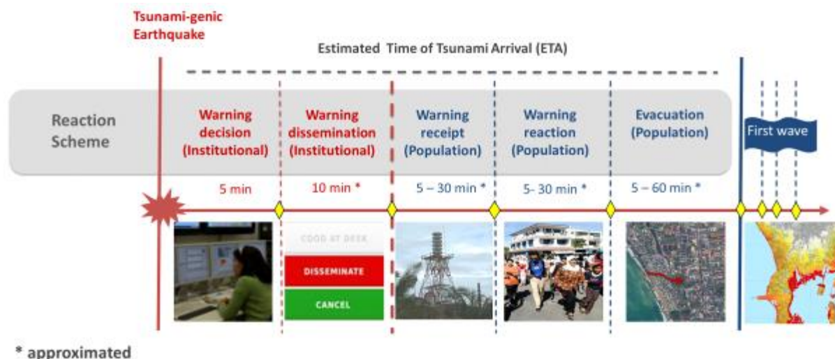
Figur 3: Tidsforløb fra detektion af et stort jordskælv til evakuering af befolkningen i Indonesien. Et automatisk system præsenterer data og simulationer, og på basis af dette træffes beslutning af vagtpersonale om udsendelse af varsel. Kilde: GFZ.
