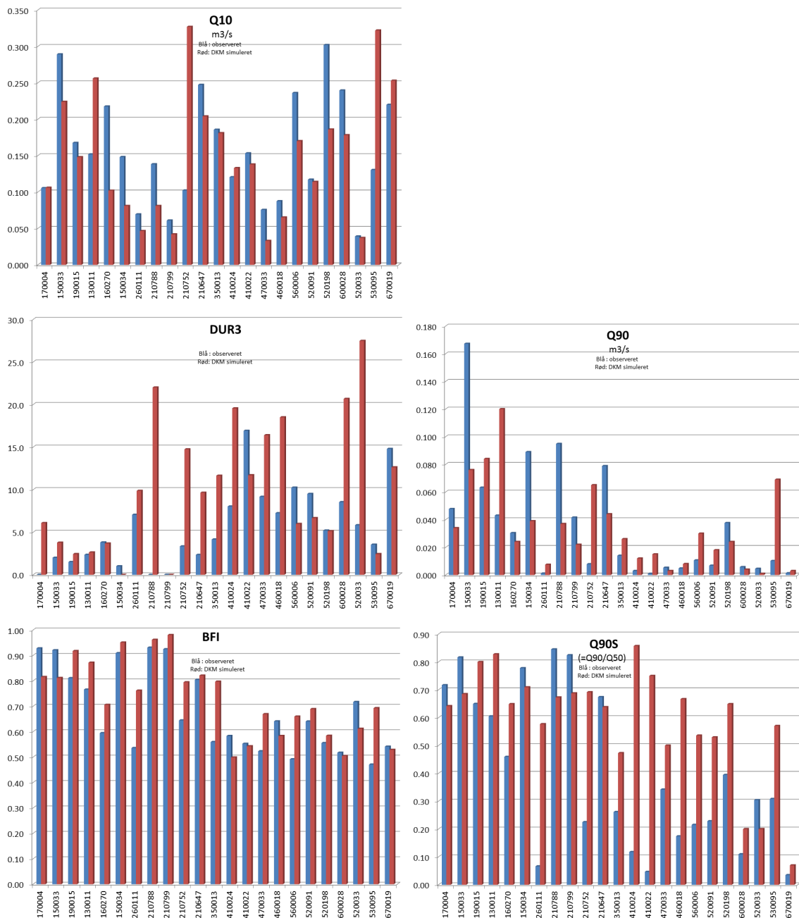
Figur 6.14 Sammenligning af hydrologiske regime variable beregnet ud fra observeret vandføring (blå) og DK model simuleret vandføring (rød) for 2000-2005.
