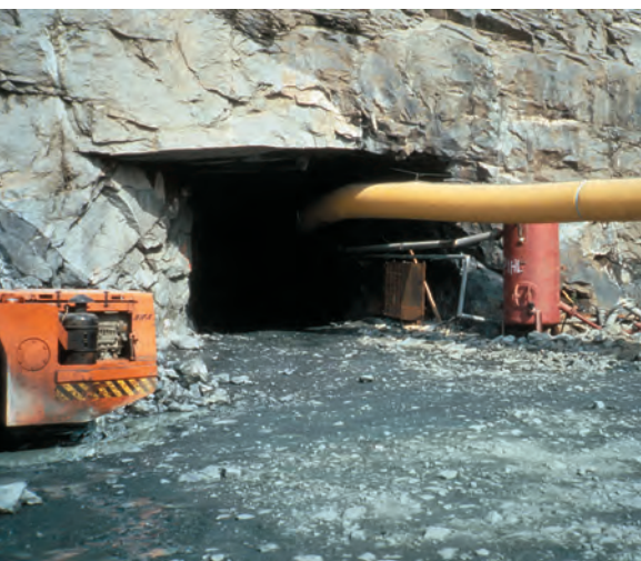
Ved fornyede undersøgelser på Kvanefjeld 1978 blev der sprængt en 960 m lang tunnel, hvorfra 20 000 ton malm blev hentet. Det kraftige udsugningsanlæg, som sikrer at radonmængden ledes væk fra minen, ses som et gult rør.
