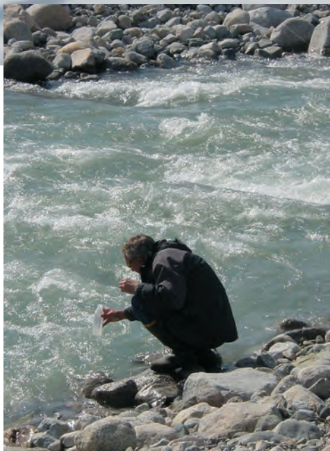
Både før, under og efter etableringen af en mine udtages vandprøver for at overvåge miljøet. Her er det Nalunaq Gold Mine AIS' laboratorieansvarlige, som indsamler vandprøver fra elven i Kirkespirdalen.
