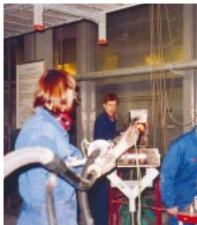
Figur 3. Billede af prøveudtagning af kokspartikler i brændzonen på Fynsværket. Partiklerne suges ud gennem en vandkølet sonde.
