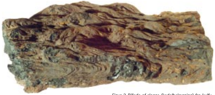
Figur 2. Billede af slagge (kedelbelægning) fra kulfyret kraftværk.
